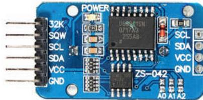
**Figure 6. DS3231 RTC Module**
