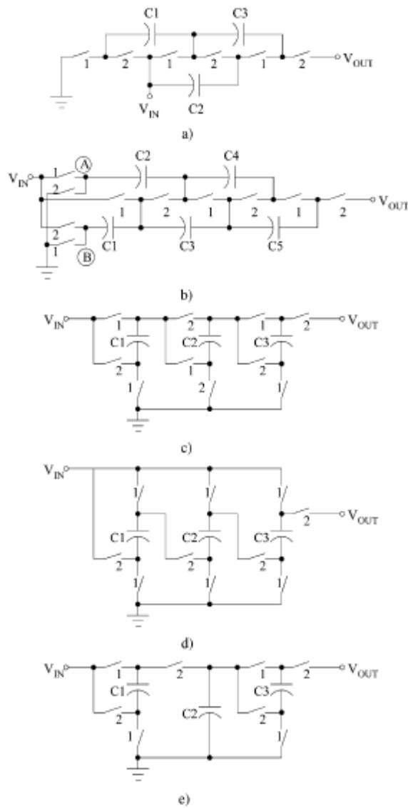
Figure 4. 5 step SC converter topology (a) ladder (b) Cock-croft-walton multiplier (c) Fibonacci (d) series-parallel (e) doubler
