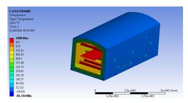
FIG 3.7 TEMPERATURE DISTRIBUTION
