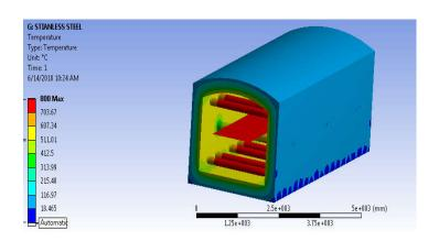
FIG 4.0 TEMPERATURE DISTRIBUTION
